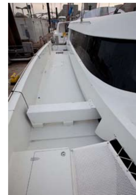
Massiv: In den Kästen sind die verschiebbaren Beams untergebracht
