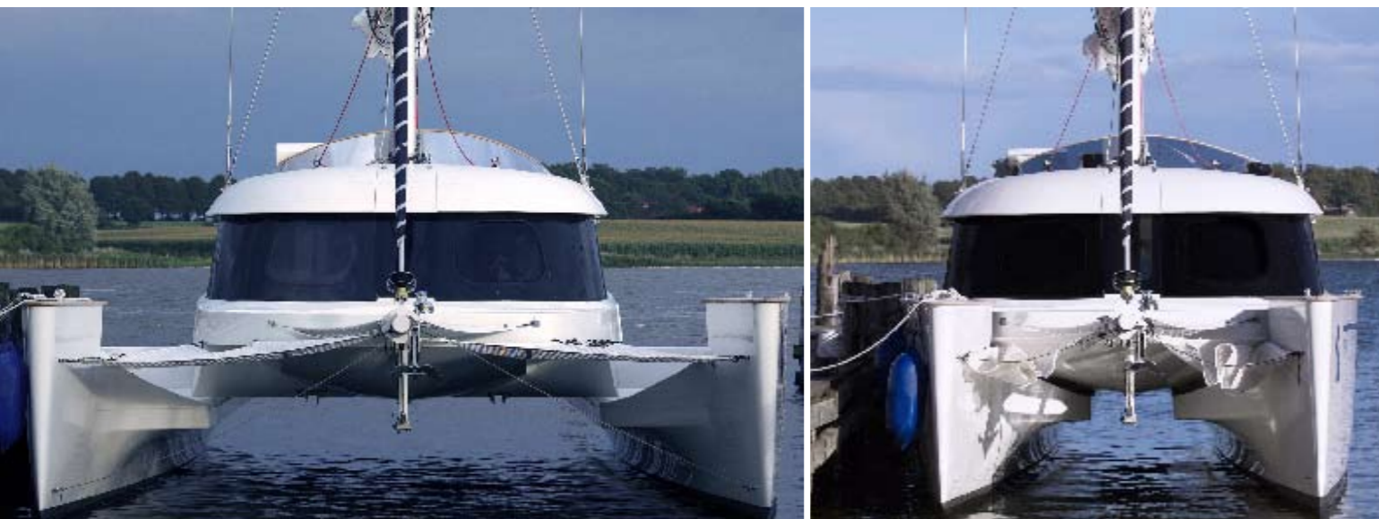
Variabel: Die beiden Schwimmer fahren an und unter die Gondel
