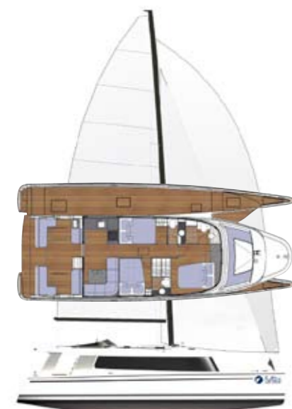
Variabel: Die beiden Schwimmer fahren an und unter die Gondel
